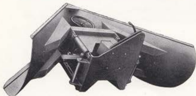
PLUG ODSNIEŻNY DWUSTRONNY — TYP POD-5A przystosowany jest do pojazdów samochodowych o nośności 5—8 ton (np. Skoda 706 RT i 706 RTS, Tatra III R, Praga V3S, Studebaker)
