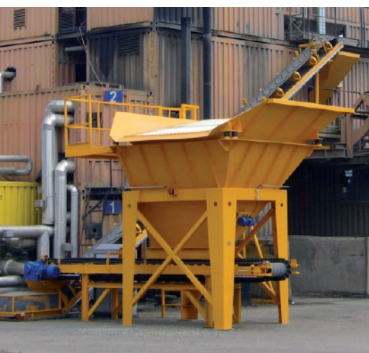
System dozowania destruktu do wytwórni mas bitumicznych opracowany przez firmę Madro-Kraków
